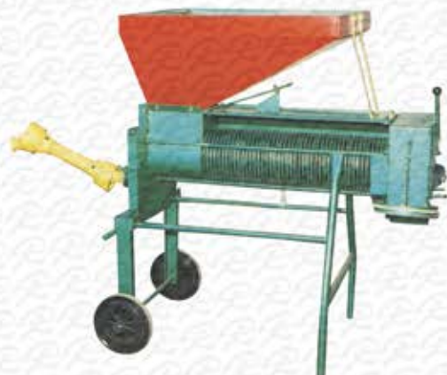
SISTEMA DE LIMPIEZA: Rodillos en espiral
